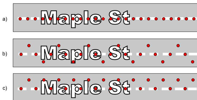
**Abbildung 6.2:** Drei verschiedene Abtastmuster zur Approximation der Sichtbarkeit: a) Mittellinien-Muster, b) Sägezahn-Muster, c) auf die obere Texthälfte beschränktes Sägezahnmuster.
