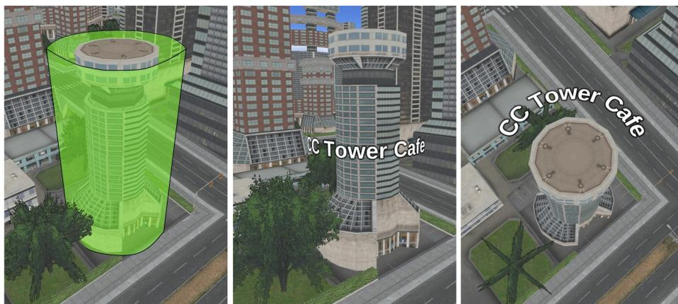
**Abbildung 7.2:** Generalisierung eines Gebäudes durch eine Zylinderhülle und mögliche Varianten zur Einbettung einer Beschriftung.
