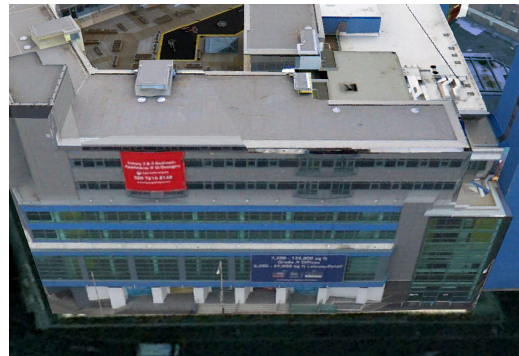
(b) Mit Farbausgleich: Die Färbung innerhalb der Flächen ist homogener. Farbunterschiede zwischen Flächen können jedoch verstärkt werden.
