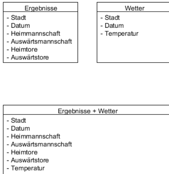
Abbildung 3.9: Einfacher Join, der die Ergebnis- und Wetterdaten zu einer flachen Datenstruktur verbindet
